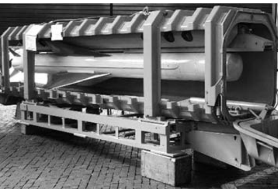
Corte de un contenedor con misil Exocet MM-38.
